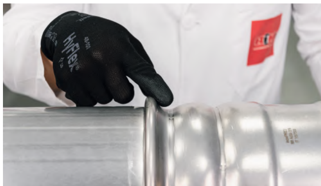
Рис. 36. Визуальный осмотр места прессования Oversize.
